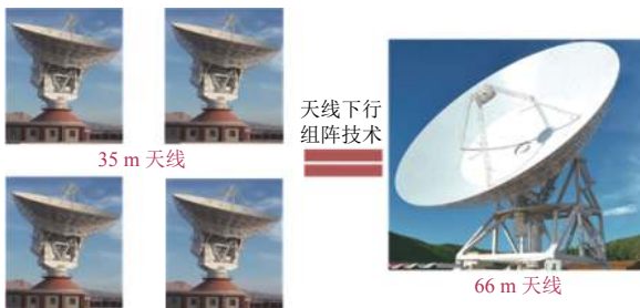
图 11 喀什4 × 35 m天线组阵示意图 Fig. 11 Diagram of Kashi 4 × 35 m antenna array
