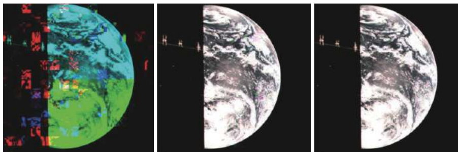
(a) 12 m 天线接收 (b) 4×12 m 组阵接收 (c) 50 m 天线接收
