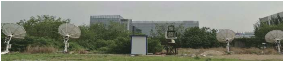
图 14 国内上行组阵试验系统外场图 Fig. 14 Uplink arraying experiment system
