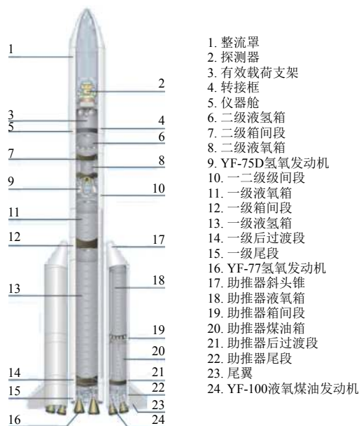
图2 “长征五号”火箭剖视图 Fig. 2 Section view of the LM-5
