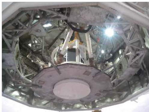
图3 FAST 19波束接收机安装在馈源舱内Stewart平台的下平台上
