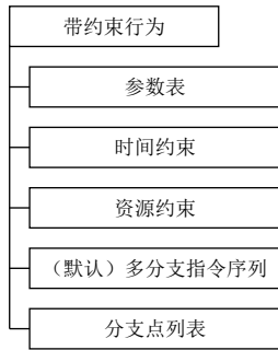
图4 带约束的行为对象结构示意图
