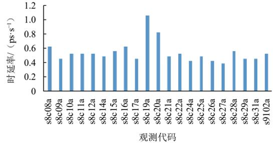
图 17 “嫦娥4号”探测器任务时延率数据定轨后残差统计
