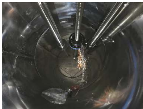
图17 钻具上热电偶的引出与转接
