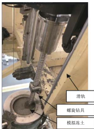
(a) 原理样机钻进试验
