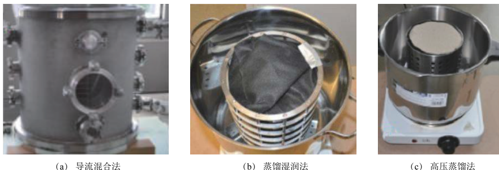
图4 冻土月壤模拟物制备方法
