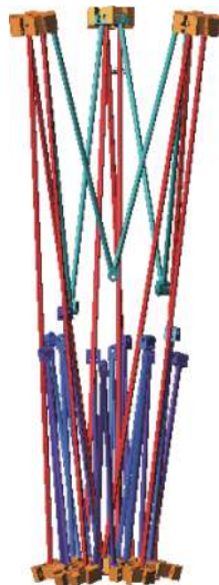
图11 最小组合单元机构收拢状态
