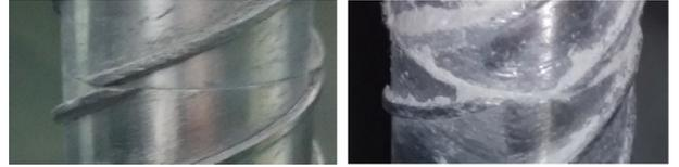
图2 连接螺纹错位现象
