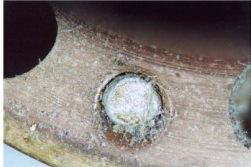
图6 受真菌污染的俄罗斯空间站烟感探测器<sup>[24]</sup>
