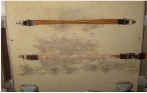
图9 空间站上受到霉菌侵蚀污染的FGB纤维板<sup>[61]</sup>
