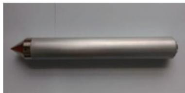
(b) 凸轮机构储能式贯入器
