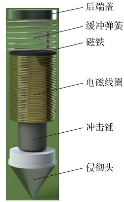
图 6 电磁储能式贯入器本体组成图
