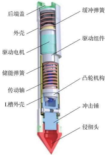
图 4 凸轮储能式贯入器本体组成图
