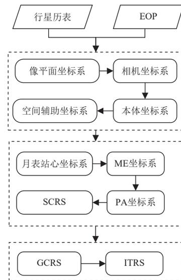
图 2 月基对地观测的严格成像模型
