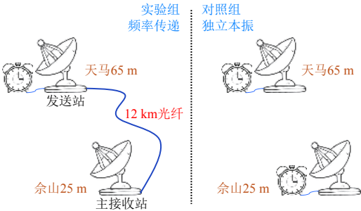
图 13 VLBI实际观测验证示意图 Fig. 13 Diagram of VLBI observation experiment
