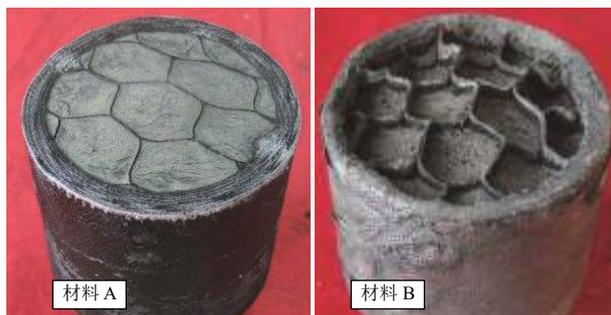
图1 材料A和B的烧蚀形貌
