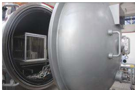
图6 “长征五号”火箭箭载设备热真空试验
