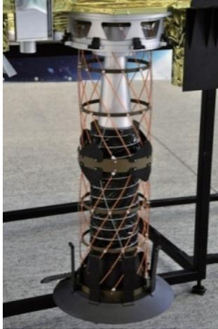
图 5 Hayabusa 采样装置示意图
