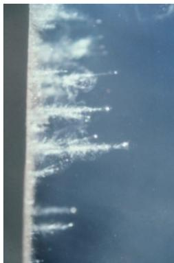
图3 粒子在气凝胶中的轨迹示意图
