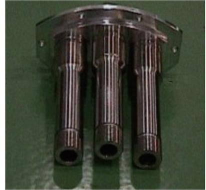
图 6 Hayabusa 抛射装置示意图
